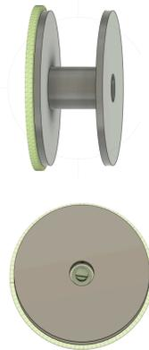
El **sistema retráctil** se logra mediante un **resorte interno** ajustado al centro y conectado al **carrete**. Cuando se tira de la correa, el resorte se desenrolla, y cuando se suelta, se vuelve a enrollar, haciendo que la correa se guarde de nuevo dentro de la carcasa.
