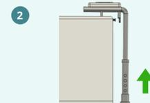
Ajustar las patas del dispositivo al piso del baño.
