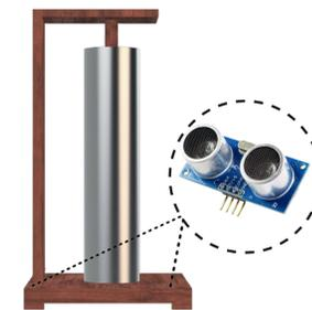
**Detección de proximidad:** Mediante **sensores de ultrasonido**, se **detecta la cercanía** del perro y este le **envía la señal** para que se **encienda** el rascador.
